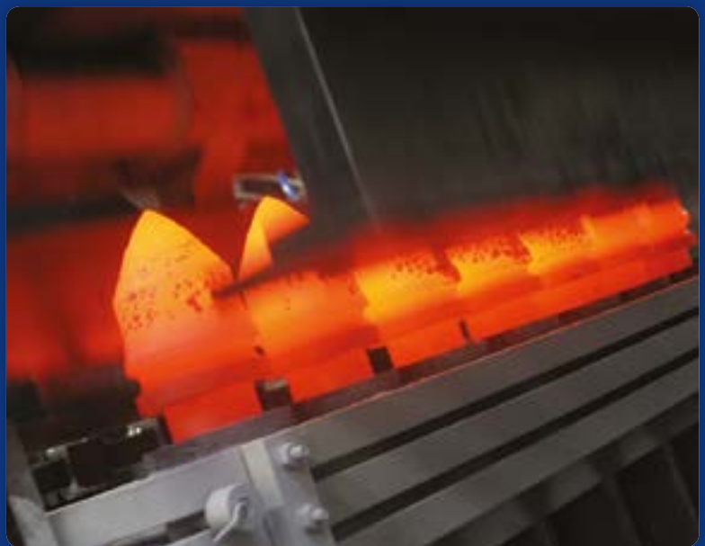
Das Löten für eine dauerhafte Verbindung von Hartmetall und Stahl
